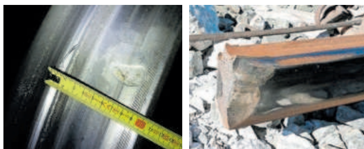
Marcas en una rueda del tren y posible zona de colisión con el carril.
